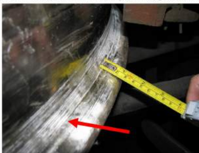
Imaginea 5 - urme de cuțit rezultate în urma unui proces tehnologic de așchiere
