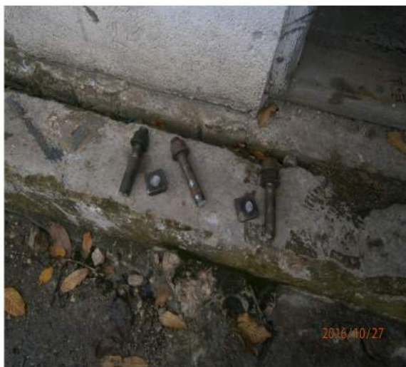
Foto 1 – buloanele orizontale secționare
