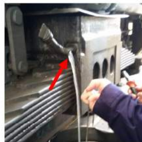
Imaginea 6 - cantitatea de apă scursă la boghiul 2 nederaiat a fost mai mare decât la boghiul deraiat
