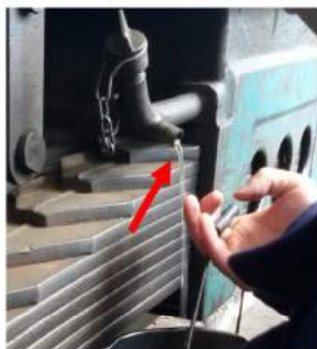
Imaginea 7 - cantitatea de apă scursă la boghiul 1 deraiat a fost mai mică decât la boghiul nederaiat
