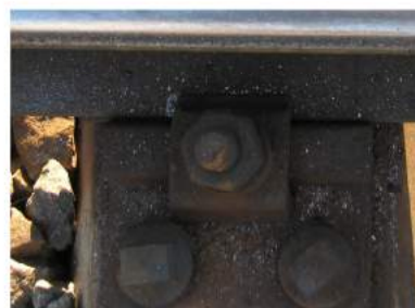
Imaginea 10 - material desprins din suprafețele aflate în contact sub formă de pilitură metalică
