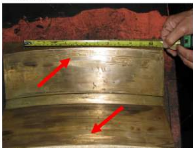
Imaginea 8 - șanțuri produse de frecare, pe suprafața activă a plăcilor de alunecare din bronz, de la boghiul 1 deraiat, partea stângă.
