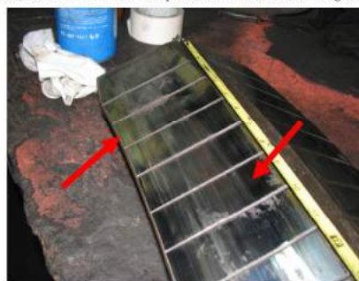
Imaginea 9 - undulații pe suprafața activă a sabotului de alunecare din oțel de la boghiul 1 deraiat stângă, rezultate în urma frecării cu placa de alunecare din bronz.
