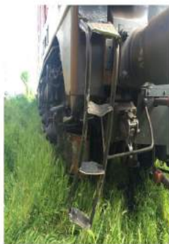
Fig. 6 - Scara de colt deformată
